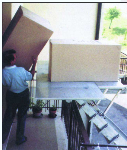
Pianale all'interno del balcone
