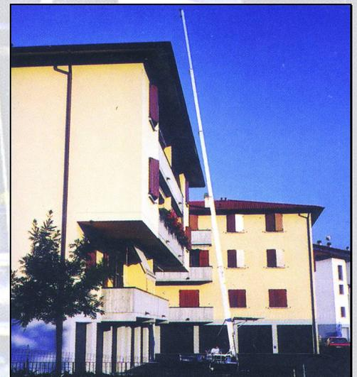
Il pacco scale realizzato in lega di alluminio EN AW-7020 conferisce agli elevatori Scala Reale una robustezza unica: alla massima altezza non si apprezza la minima incurvatura delle scale.
