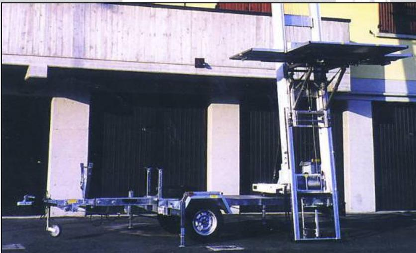
Il sistema di blocco scale a barre d'acciaio inossidabile (sistema esclusivo ideato da Scala Reale) impedisce al pacco scale di abbassarsi a seguito della flessione delle funi d'acciaio quando si carica la piattaforma. Il bloccaggio e lo sbloccaggio rapido dello scivolo di prolunga a terra, si ottengono agendo su un'unica leva.
