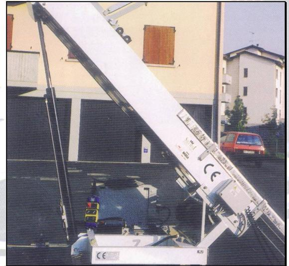
Il doppio cilindro di sollevamento del pacco scale, adottato negli elevatori da 24 metri in poi, elimina i problemi di svergolamento del pacco scale. La ralla è dotata di un doppio sistema frenante: a pattino con posizione di bloccaggio millimetrica e meccanico a tre posizioni obbligate per ognuna delle tre zone di lavoro dell'elevatore (frontale e sui due lati del rimorchio).
