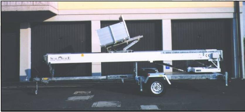
La larghezza del rimorchio è di mm 1500, la lunghezza massima varia da un minimo di 5 metri a un massimo di 5,87 metri a seconda dei modelli di elevatori installati.
