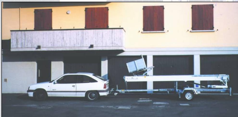
Il rimorchio è dotato di freno di stazionamento e di sistema frenante ad inerzia. Date le modeste masse complessive (750 kg e 1000 kg a seconda dei modelli di elevatori installati), è possibile il traino con gran parte delle autovetture commerciali. L'installazione su rimorchio "leggero" (massa complessiva 750 kg) è possibile per elevatori fino a un' altezza di 23 metri.
