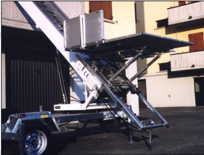
Le quattro sponde, tutte separabili dalle piattaforme, sono dotate di supporti in acciaio a "elle" per posizioni orizzontali e verticali. Dimensioni della piattaforma (girevole e rientrabile nella finestra): mm 1422x830, sponda anteriore alta mm 650 sponde laterali alte mm 450, sponda posteriore alta mm 250 larga mm 600.
