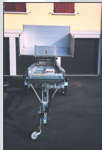
Sulla testata degli elevatori sono presenti i pulsanti di salita, discesa e arresto di emergenza. La sponda anteriore della piattaforma è ribaltabile e amovibile.
