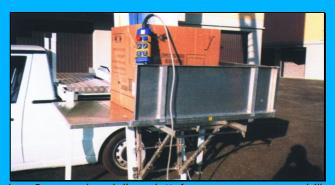
Le 3 sponde delle piattaforme sono separabili, posizionabili in orizzontale o in verticale. Dimensioni della piattaforma chiusa: mm 1230x830; aperta: mm 1990x1210; sponde alte mm 380. Il pianale di carico può essere ruotato ed entrare nella finestra o balcone, grazie a una barra di prolunga, agevolando maggiormente le operazioni di carico e scarico.
