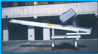
L'elevatore in pochi istanti può essere separato dal pick-up e lavorare autonomamente o essere lasciato a magazzino: il suo basamento è dotato di proprie ruote.
