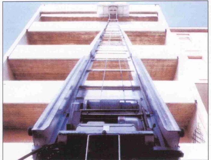
■ Carga útil: 200 kg. en la máxima altura.
